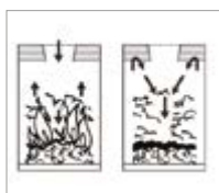
Principio di autoestinzione Auto-estinguente
