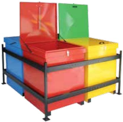
Struttura composta da quattro contenitori di sicurezza indipendenti porta Big Bag e da una struttura perimetrale. Quest'ultima è dotata di sponda apribile per agevolare le operazioni di movimentazione dei singoli contenitori tramite carrello elevatore o transpallet.
