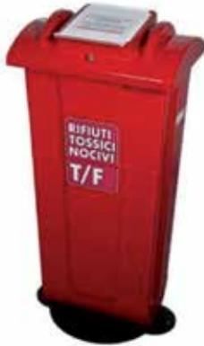
Contenitore in polietilene costruito con la tecnica rotazionale per garantire resistenza agli urti, all'invecchiamento e allo scolorimento. Il coperchio è in ABS termoformato e bloccato al contenitore mediante serratura a triangolo completo di sportello antintrusione.
