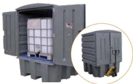
Armadio dotato di vasca di raccolta interna. Doppia porta a battente fissata con cerniere in INOX e chiusura a chiave. Soluzione ideale per lo stoccaggio di prodotti corrosivi. Adatto al posizionamento di 1 cisternetta da 1000 L o 4 fusti da 200 L.
