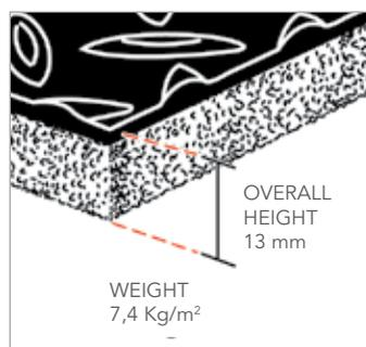
Passatoia multifunzione, anti-fatica composta da schiuma fusa termicamente con una superficie di rivestimento robusta, antiscivolo, con disegno a scacchi. Resistente ai prodotti chimici, all'olio e agli acidi.
