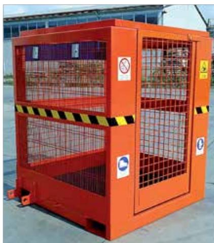
Cestello per la manutenzione aerea con porta a molla e dispositivo di bloccaggio, dotato di fermo di sicurezza che evita lo sfilamento del contenitore dalle forche e di ganci per l'attacco delle cinture di sicurezza. Completo di tappetino antiscivolo e vaschetta porta-attrezzi. Colore RAL 2004 ad alta visibilità. Attrezzatura ammessa solo in caso di emergenze. Non utilizzabile in situazioni ordinarie.
