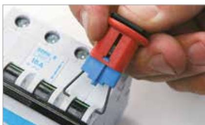
Sistema efficace per il bloccaggio degli interruttori magnetotermici Europei. Si installa semplicemente con l'aiuto di un pulsante a pressione. Il modello TBLO ha invece una pratica rotella di chiusura a vite per un'applicazione veloce. Robusto, in nylon caricato con fibra di vetro. Da utilizzare in combinazione con un lucchetto con l'arco da 6 mm di diametro.
