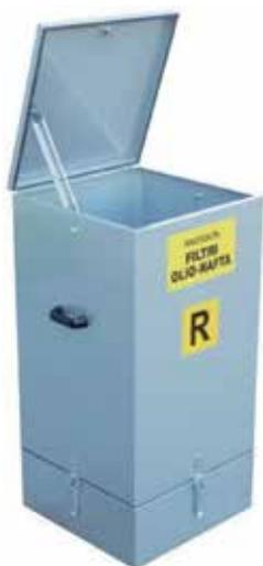
Contenitore in acciaio, composto da due moduli sovrapposti distinti e separabili: Modulo superiore: con coperchio incernierato con asta di sicurezza antichiusura accidentale autobloccante a 45° e 90° e maniglia superiore, fondo grigliato in acciaio zincato per passaggio liquidi di scolo, vasca di fondo per raccolta liquidi: asportabile dal modulo superiore con aggancio rapido tramite leve in acciaio con scatto a pressione.
