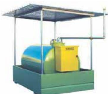
Tettoia di protezione dagli agenti atmosferici, realizzata con robusto telaio in acciaio al carbonio zincato e copertura in lamiera grecata zincata autoportante; è realizzata per essere montata e fissata mediante bulloni agli alloggiamenti ricavati nei bacini di contenimento.
