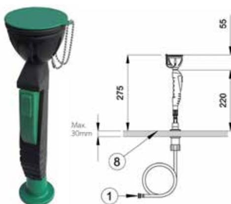
Sistema di lavaggio oculare di emergenza per l'installazione di un piano di lavoro a bassa pressione ad alta pressione con valvola a flusso totale, apertura manuale a pulsante. Colore verde RAL 6029. Adatto per industrie, officine, laboratori e in generale dove esiste il rischio di danni da fuoco, acidi, reagenti, prodotti petroliferi, materiali radioattivi o qualsiasi altro elemento inquinante.
