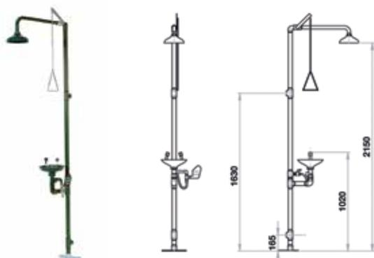
Doccia combinata con lavaocchi, soffione in polipropilene colore verde completo di valvola a chiusura manuale con azionamento a mezzo di tirante rigido con comando a triangolo. Lavaocchi a flusso aerato completo di valvola a chiusura manuale con apertura a mezzo di push laterale, bacinella in polipropilene colore verde.
