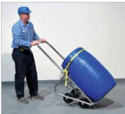
Carrello comprensivo di accessorio per movimentare fusti in plastica o acciaio bordati, o non bordati:
