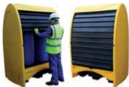
Armadio in polietilene ad alta densità con vasca di raccolta, resistente ai raggi UV e agli agenti chimici più aggressivi. Adatto allo stoccaggio all'aperto. Le porte a saracinesca presenti sul lato anteriore e posteriore permettono un'eccellente protezione da agenti atmosferici e polvere. Predisposizione a chiusura con lucchetto (non fornito). Inforcabile con muletto.
