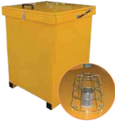
Contenitore di sicurezza per lo stoccaggio temporaneo di scarti a pianta quadrangolare con carenatura portante in acciaio al carbonio. Trattamento esterno anticorrosione ottenuto con resine poliuretatiche antistatiche di colore visibile. Disponibile nei modelli con portellone superiore asportabile o con portellone incernierato servoassistito con 2 pistoni a gas (apertura 95°).
