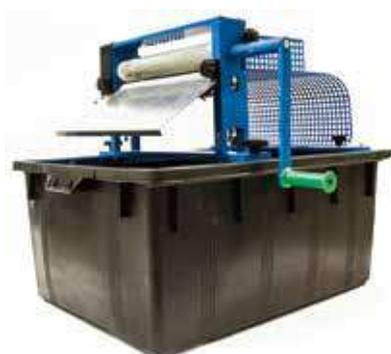
Strizzatore meccanico per recupero idrocarburi realizzato in alluminio e materiali plastici
