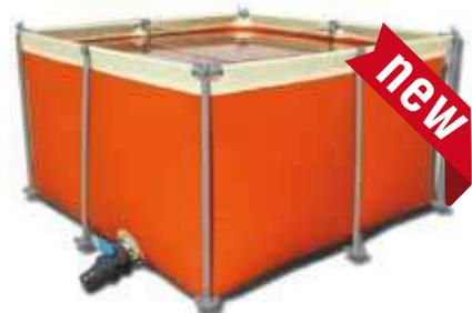
Serbatoio flessibile con armatura a sezione rettangolare. Costruito in tessuto poliestere extraforte rivestito con plastomeri, supportato da un telaio metallico di facile assemblaggio. Serbatoio adatto al contenimento di acqua e fanghi bentonitici; pratico in quanto è facilmente ripiegabile e immagazzinabile in spazi ridotti, completo di valvola da 2 pollici per il carico e lo scarico con portagomma da 60 mm e kit di riparazione. Disponibili di altre capacità.
