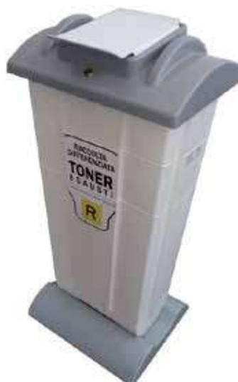
Contenitore in polietilene costruito con la tecnica rotazionale per garantire resistenza agli urti, all'invecchiamento e allo scolorimento. Il coperchio è in ABS termoformato e bloccato al contenitore mediante serratura a triangolo completo di sportello antintrusione.
