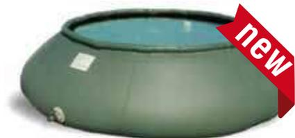
Serbatoio flessibile autoportante a sezione circolare con bordo superiore galleggiante. Costruito in tessuto poliestere extraforte rivestito con plastomeri. Serbatoio adatto al contenimento di acqua; pratico in quanto è facilmente ripiegabile e immagazzinabile in spazi ridotti, completo di valvola da 2 pollici per il carico e lo scarico con portagomma da 60 mm e kit di riparazione. Disponibili di altre capacità.
