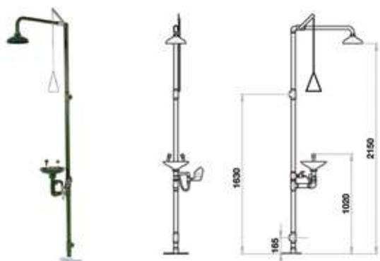
Doccia combinata con lavaocchi, soffione in polipropilene colore verde completo di valvola a chiusura manuale con azionamento a mezzo di tirante rigido con comando a triangolo. Lavaocchi a flusso aerato completo di valvola a chiusura manuale con apertura a mezzo di push laterale, bacinella in polipropilene colore verde.
