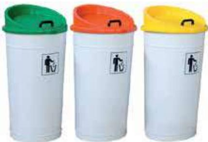
I contenitori costruiti in polietilene con la tecnica del rotazionale. Questo materiale, così stampato, garantisce grande resistenza agli urti, all'invecchiamento, nonché allo scolorimento. I coperchi sono costruiti in ABS termoformato e poi colorati con le migliori vernici bicomponenti e completi di maniglia. I contenitori sono forniti con un basamento in polietilene zavorrabile.
