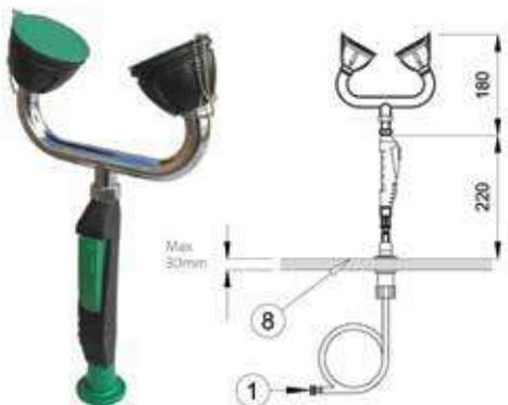
Sistema di emergenza a doppio lavaggio oculare. Per alta pressione e bassa pressione. Installazione del piano di lavoro con valvola a flusso totale, apertura manuale a pulsante. Doppio getto aerato con parapolvere. Colore verde RAL 6029. Adatto per industrie, officine, laboratori e in generale dove esiste il rischio di danni da fuoco, acidi, reagenti, prodotti petroliferi, materiali radioattivi o qualsiasi altro elemento inquinante.
