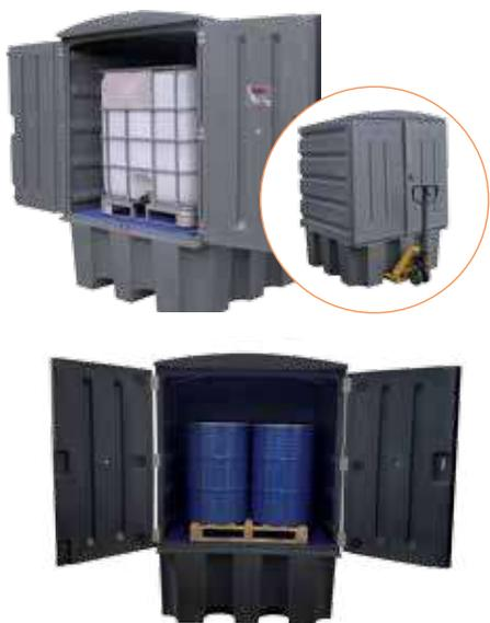
Armadio dotato di vasca di raccolta interna. Doppia porta a battente fissata con cerniere in INOX e chiusura a chiave. Soluzione ideale per lo stoccaggio di prodotti corrosivi. Adatto al posizionamento di 1 cisternetta da 1000 L o 4 fusti da 200 L.
