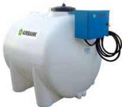
Serbatoio cilindrico orizzontale in polietilene ad alta densità per urea in concentrazione massima del 30% a pressione atmosferica.
