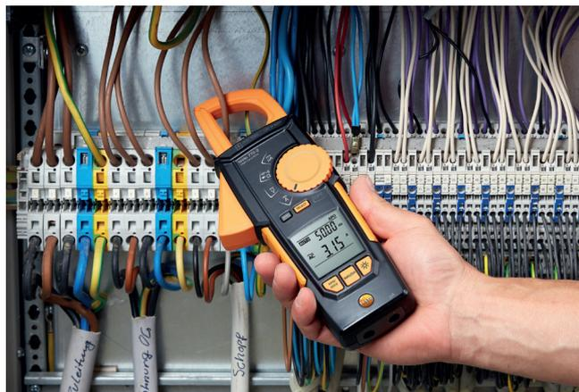
Misurazione della corrente su un quadro elettrico.
