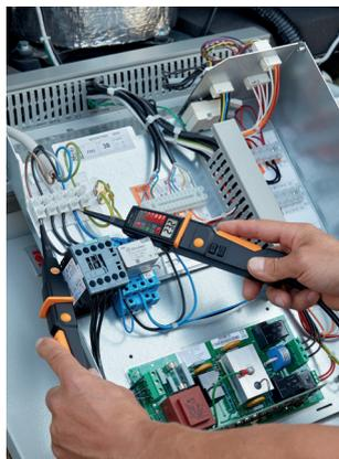
Misura della tensione su misura della tensione su caldaia.
