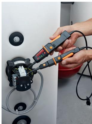
Misura della tensione su caldaia.
