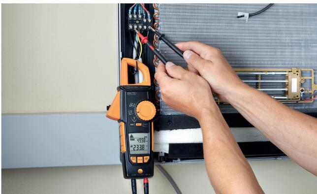
Misura della tensione su un condizionatore d'aria con **Testo 770.**
