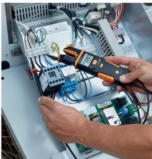
Misurazione della tensione di un compressore.
